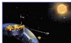
Avec une configuration de vol en tétraèdre, les satellites Cluster II sont capables de donner une description tridimensionnelle du champ magnétique terrestre et de ses zones d'interaction avec le vent solaire. Crédit [NASA](#)
